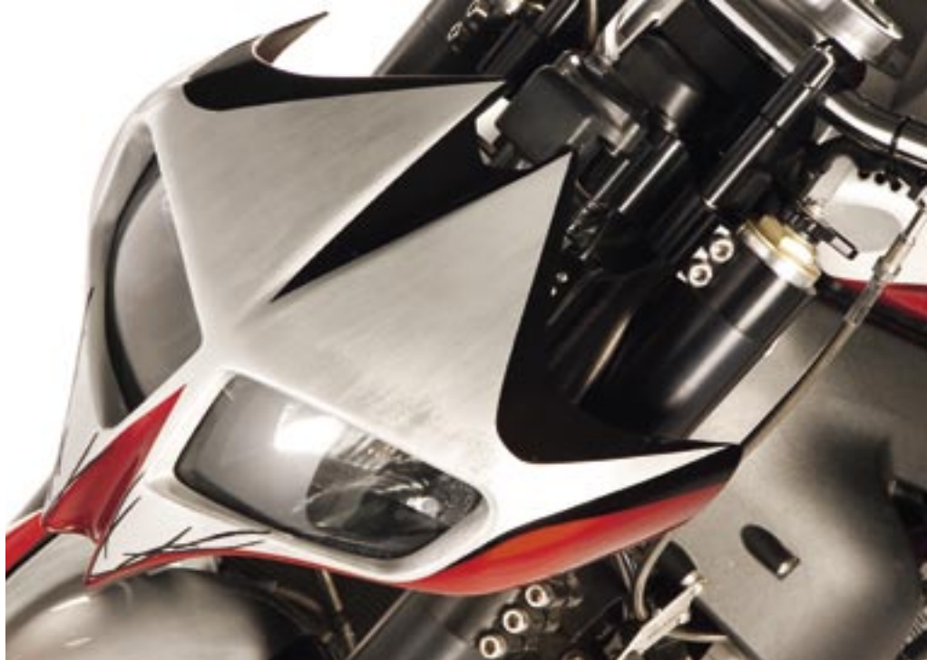
Des Teufels General: Das Fernlicht wurde von H8 auf Xenon umgebaut
